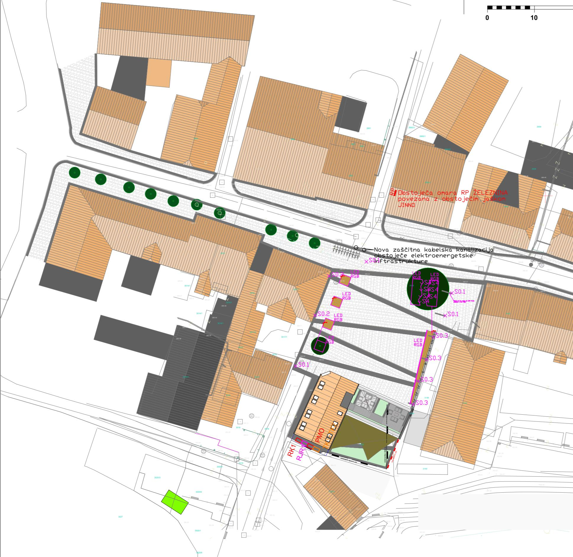
**PMO** Podzemna priključna merilna omara PMO - z ločenim delom za priklop dimenzij min. š650xg190xv450mm ter ločenim merilnim delom dimenzij min. š600xg190xv450mm z vrati ter montažno ploščojo plastično omraco (PVC) min. IP43; omraco je vgrajeno v fasado na označeni lokaciji - zunanjji rob omare mora biti poravnан z končnim fasadnim slojenjem; kpl z vgrajeno opremo iz sheme razdelilnika PMO z vsem potrebnim pritridlein in spojnim materialom - 1 kpl - kot npr. DMARICA PMO 4-3 DKNA, Prebil plast
